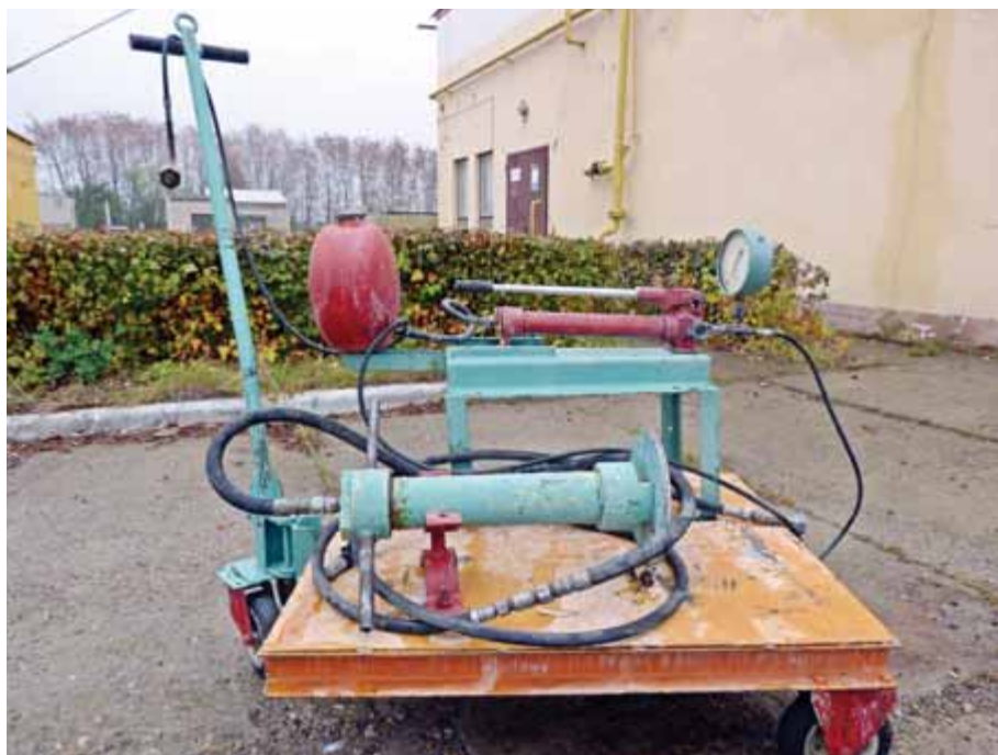
Рис. 2. Експериментальна модель комплексу для діагностування системи ущільнення «масло — газ» без заповнення контура відцентрового нагнітача технологічним газом
