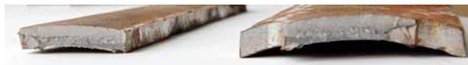
Рис. 1. Загальний вигляд поверхонь втомного руйнування зразків для мікроструктурного аналізу
