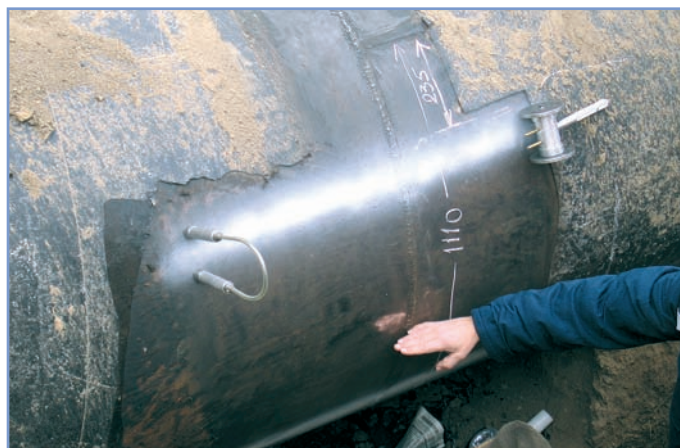
Рис. 2. Ділянка контролю. Фактична товщина металу МГ на ділянці контролю 15,7 (0,2 мм). Матеріал: сталь X-70
