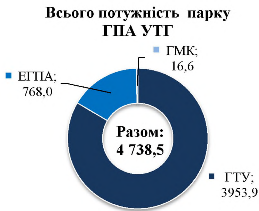
Рис. 1.11 Структура потужності парку ГПА системи транспортування за типом приводу
