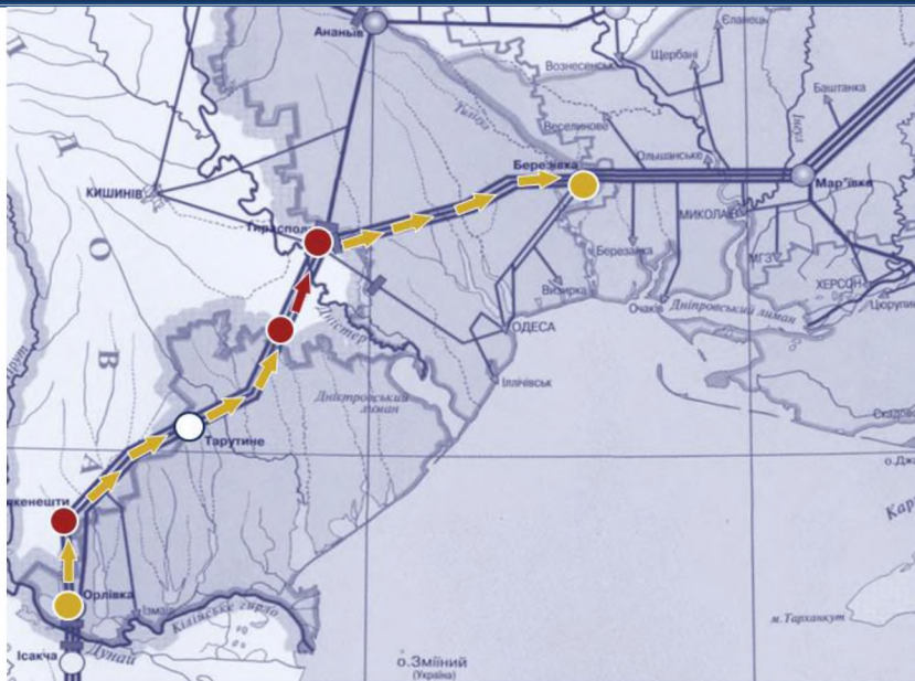
Рис. 2.4 Схема транспортування природного газу в реверсному напрямку через «Південний напрямок»
