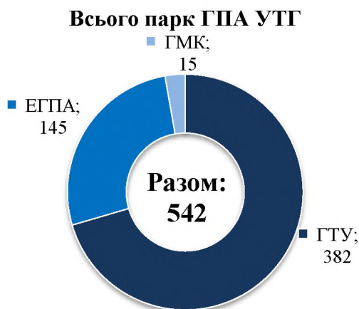
Рис. 1.9 Структура парку ГПА системи транспортування за типом приводу
